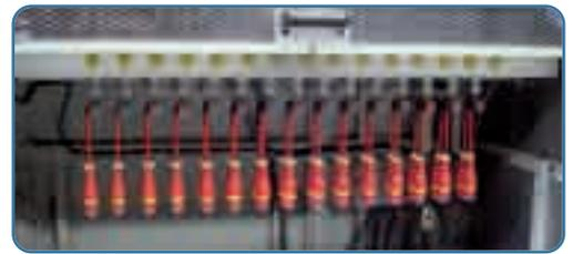
TUTTI I GIRAVITI ISOLATI SONO TESTATI IN PRODUZIONE PER IMMERSIONE IN BAGNO GALVANICO A 10.000 V
